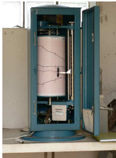
Obr. 6.1.1.1 Limnigrafická stanice a detail limnigrafu (autor: R. Pavelková Chmelová)
